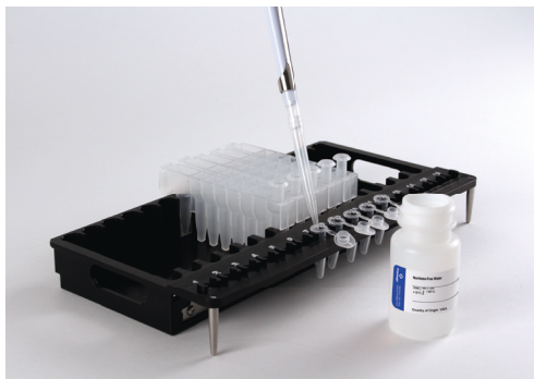
Figura 1. Instalação e configuração do tabuleiro da plataforma. A Nuclease-Free Water é adicionada aos Elution Tubes, conforme indicado. Abra os Elution Tubes antes de iniciar um método de extração.
