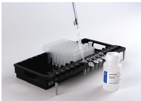
Figura 2. Instalação e configuração do(s) tabuleiro(s) de plataforma. O tampão de eluição é adicionado aos tubos de eluição, conforme indicado. O tabuleiro da plataforma é do Maxwell® CSC Instrument (Cat.# AS6000).
