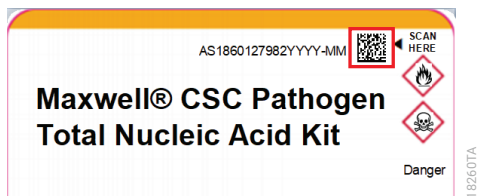
Figura 3. Etiqueta do kit que indica o código de barras do método a ler. O código de barras a ler para iniciar uma purificação é apresentado na caixa vermelha, na parte superior direita da etiqueta do kit.
