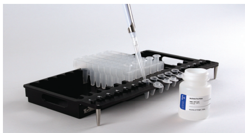
Figura 2. Instalação e configuração do(s) tabuleiro(s) de plataforma. O tampão de eluição é adicionado aos tubos de eluição, conforme apresentado. Os êmbolos encontra-se no poço n.º 8 do cartucho.
