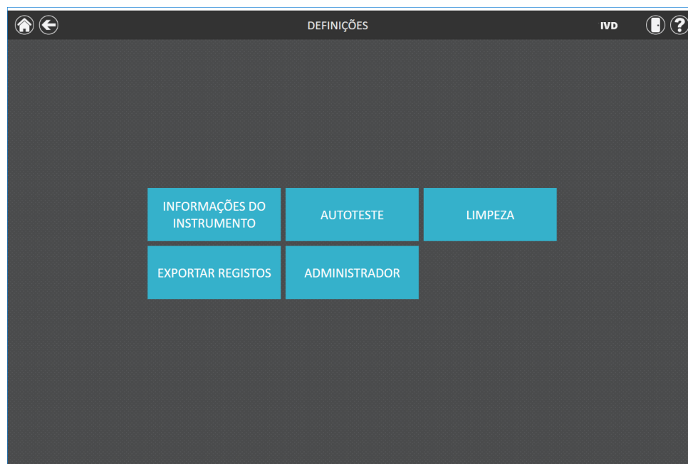
Figura 14. Ecrã "Definições" do Maxwell® CSC 48. A partir deste ecrã é possível aceder a várias funções específicas do instrumento. O botão Administrador só será apresentado nas contas de utilizador do Windows® com nível de acesso de administrador ao Maxwell® CSC 48 Software.
