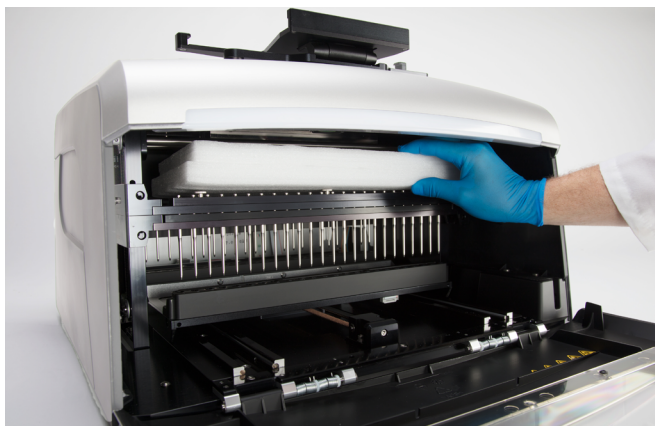
Figura 62. Colocação da almofada de espuma superior.
