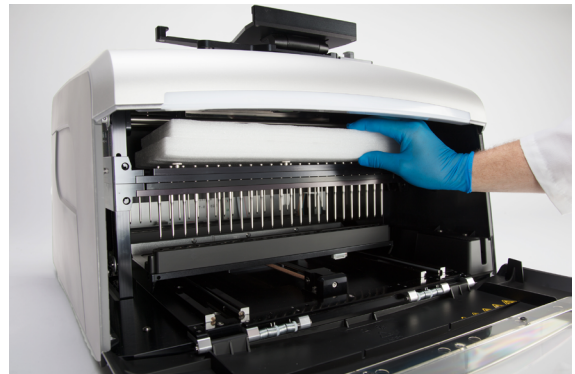
Figura 8. Remover a almofada de espuma superior do instrumento. Mova a barra magnética e a barra de êmbolos para baixo para remover a almofada de espuma superior.
