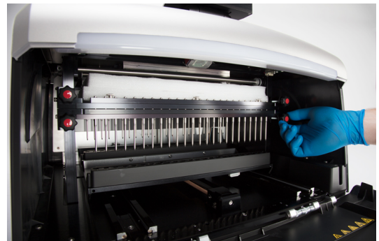
Figura 7. Remover as duas almofadas de espuma do interior do instrumento. Pannel A. Remova a almofada de espuma anterior. Pannel B. Remova os quatro parafusos de transporte das partes laterais da barra magnética anterior e barra de êmbolos.
