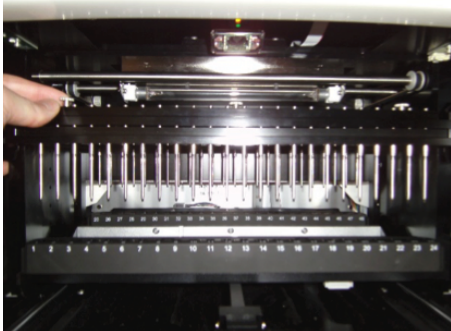
Figura 60. Remover o conjunto de varetas magnéticas anterior. Painel A. Desaperte os três parafusos que fixam o conjunto de varetas magnéticas na barra magnética. Painel B. Mova a plataforma para a frente e deslize a barra magnética para baixo. Deslize o conjunto de varetas magnéticas para cima e para a frente para o remover da barra magnética.
