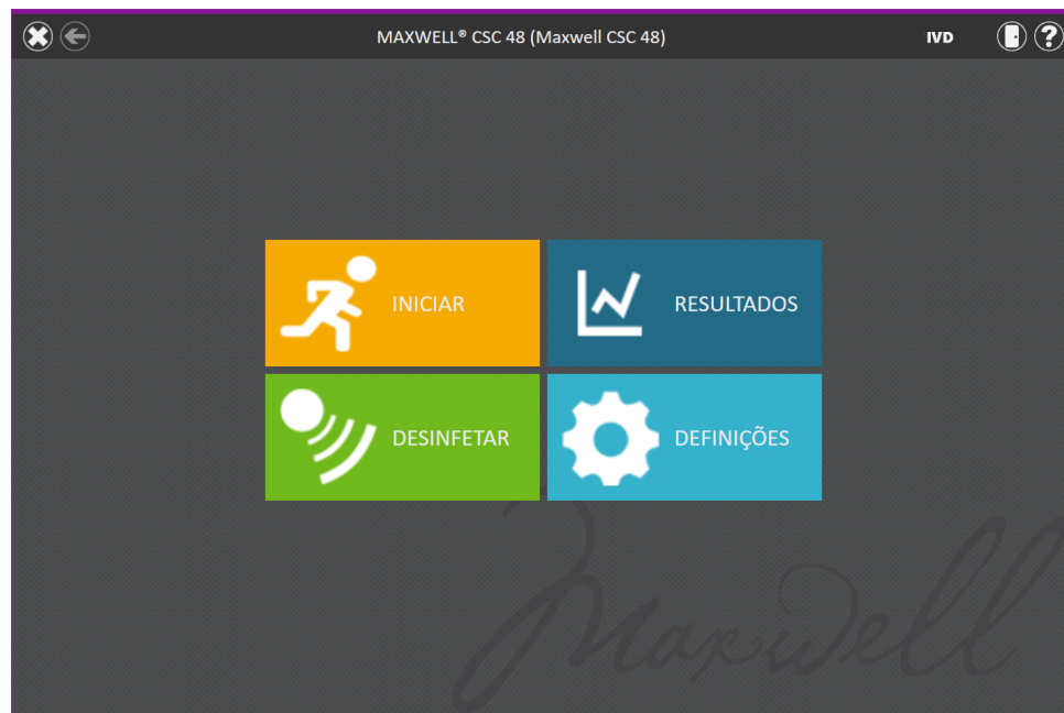
Figura 57. Ecrã "Página Inicial". Selecionar o botão Desinfetar inicia o processo de execução de um tratamento por UV do Maxwell® CSC 48 Instrument.
