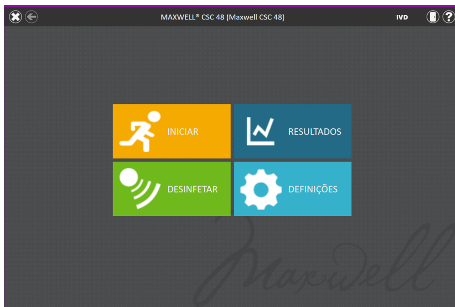
Figura 32. Ecrã "Página inicial" do Maxwell® CSC 48. A seleção do botão Iniciar dá início ao processo de execução de um método de extração no Maxwell® CSC 48 Instrument.
