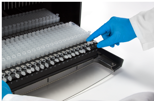
Figura 45. Fechar as tampas dos tubos de eluição.
