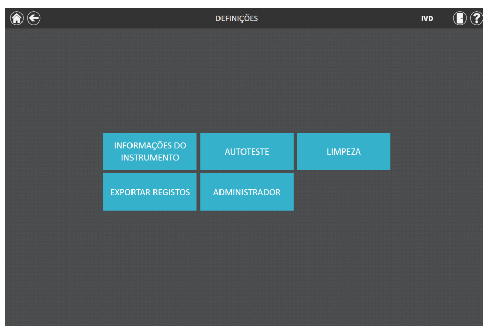
Figura 17. Ecrã "Definições" do Maxwell® CSC 48. A partir deste ecrã, pode premir Limpeza para descarregar quaisquer êmbolos ainda existentes na barra de êmbolos após uma execução de um método malsucedida.
