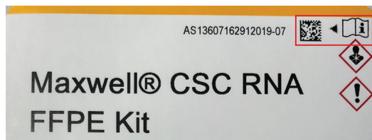
Figura 3. Etiqueta do kit que indica o código de barras a digitalizar. Digitalize o código de barras na caixa vermelha, no canto superior da etiqueta do kit, para iniciar uma execução de purificação.
