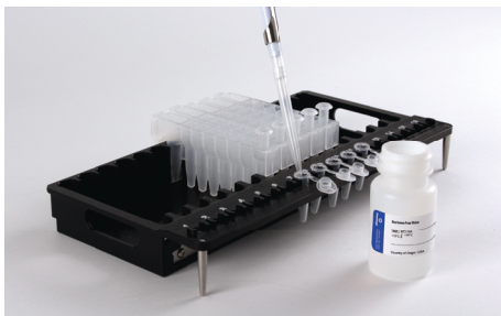
Figura 2. Instalação e configuração do tabuleiro de plataforma. A Nuclease-Free Water (50 µl) é adicionada aos tubos de eluição, conforme apresentado.
